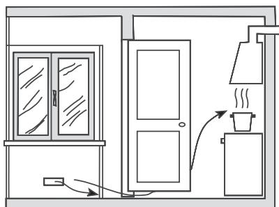
Рис. 3. Обеспечение необходимого зазора между дверью помещения и порогом для свободного прохода приточного воздуха
