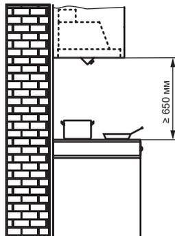
За наявності в кімнаті печі, газового котла або колонки необхідно враховувати, що під час роботи витяжка забирає з приміщення повітря, необхідне для горіння. Це стосується також приміщень з герметичними вікнами та дверима.
