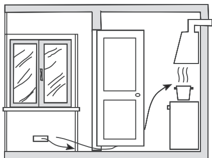
Забезпечення необхідного зазору між дверима приміщення та порогом для вільного проходу приливного повітря
